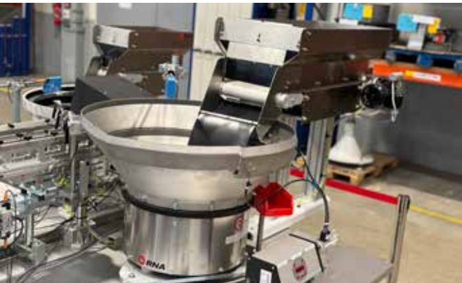
Beispielanwendung: Zuführanlage mit BUW-25 zu dosierten Befüllen
