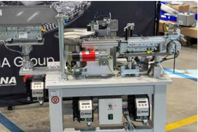
Beispielanwendung: SLL 175-250 als Staustrecke für die Zuführung in Vereinzelung
