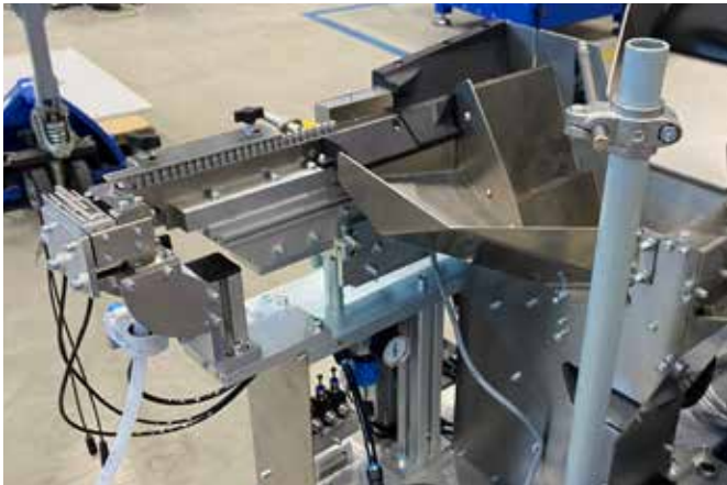
Beispielanwendung: SLA 400-400 mit linearer Sortiereinrichtung in Kombination mit Stufenförderer STS nano
