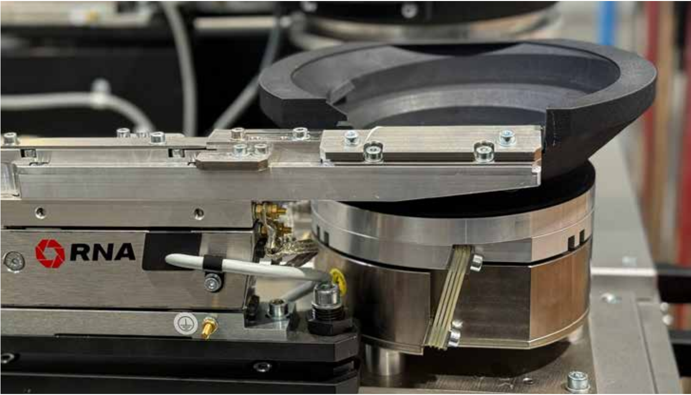
Beispielanwendung: SRC-Z 150 mit KKD-Z 150 zum Zuführen von Scheiben
