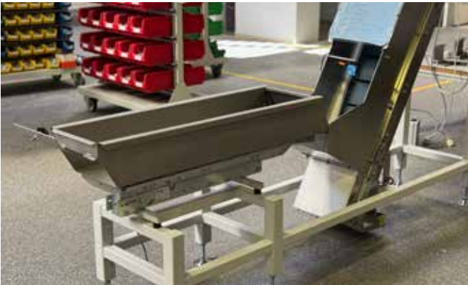
Beispielanwendung: BVL-25 SE für Bolzen zum dosierten Befüllen eines Steilförderers
