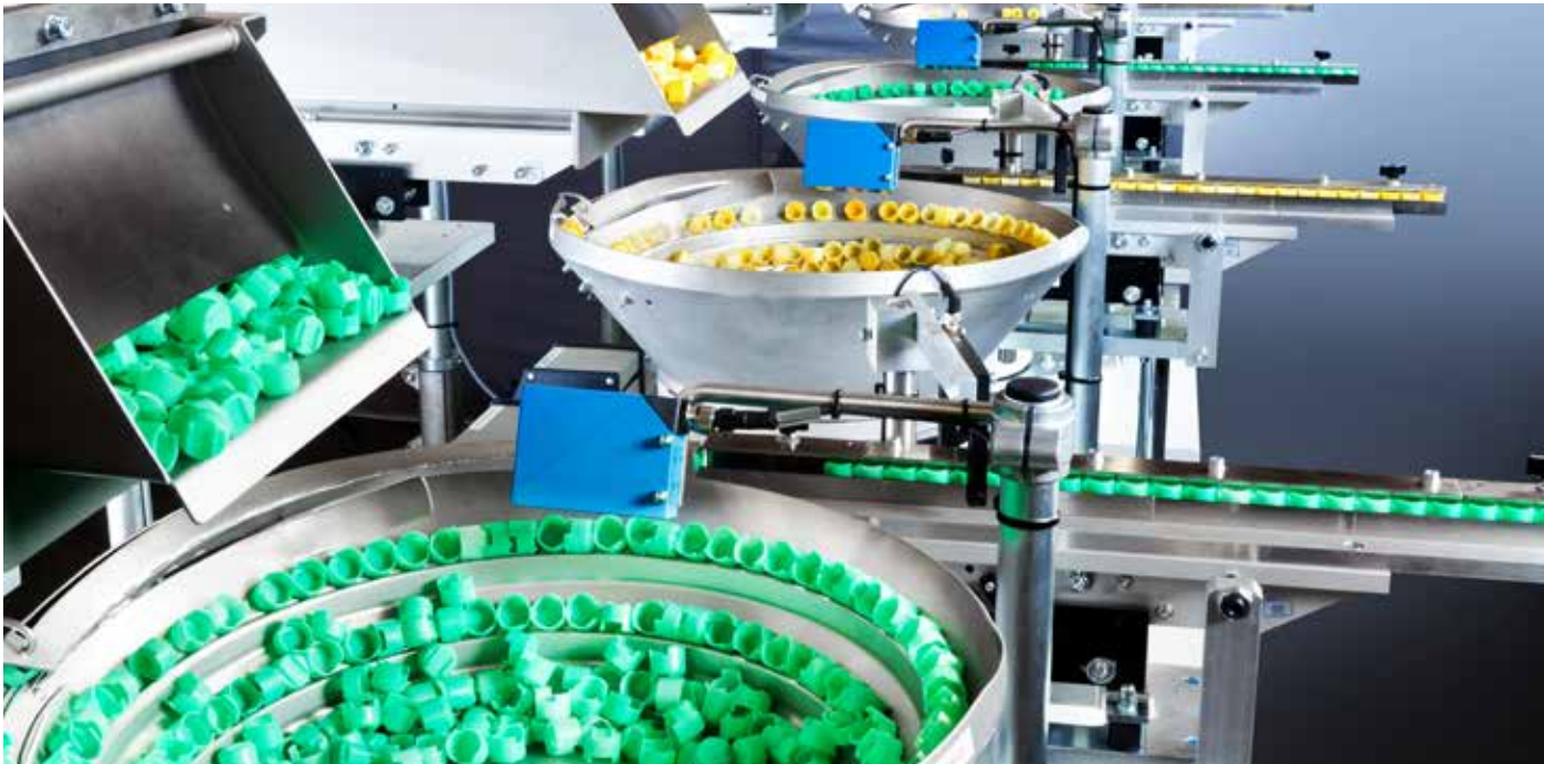
Beispielanwendung: SRC-N 250-2 mit KSB-N 250 und geschlossener Wendel zum Zuführen von Kappen
