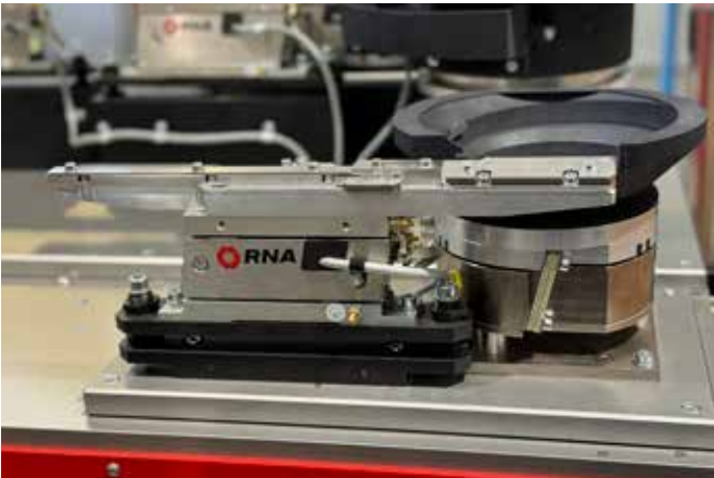
Beispielanwendung: PARU-Mini XS mit Sortiereinrichtung
