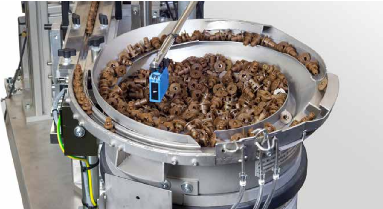
Beispielanwendung: SRC-N 250-2 mit ZSB-Z 250 zum Zuführen von Gehäusen
