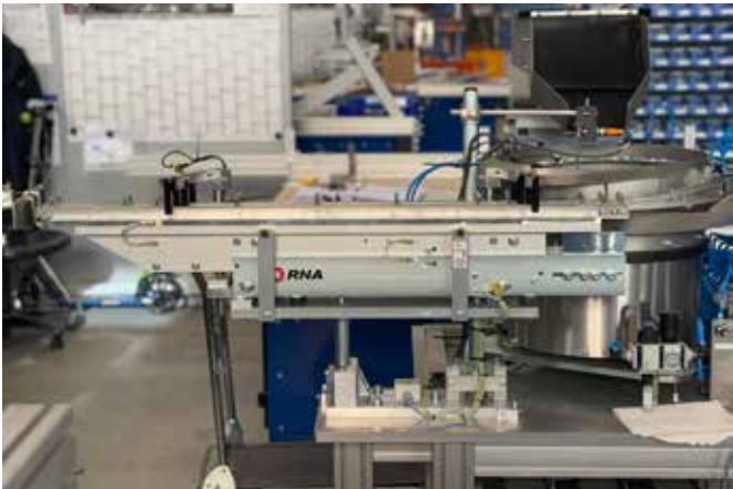
Beispielanwendung: SLL 804 als Stau- und Zubringstrecke
